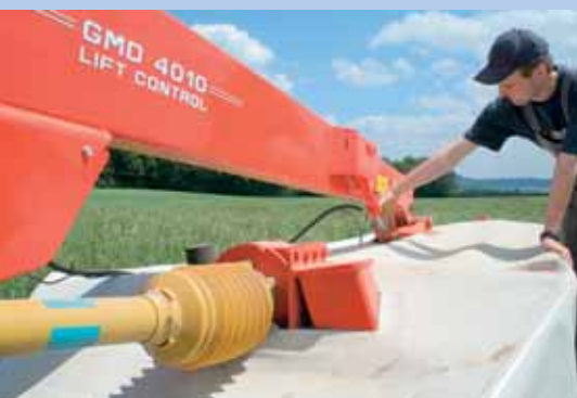
Gut: Der kleine Zylinder arretiert die Neigung und gibt den Pendelweg vor. Leider ist er vom Fahrersitz aus nicht einsehbar.
