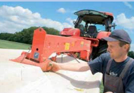
Durch die stabile Bauweise kommen 1030 kg zusammen. Beim Transport schwenkt der Mäher nach hinten.
