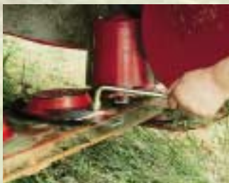
Die geschraubten Klingen lassen sich wenden, was die Standzeit erhöht. Die Mähscheiben kann man im Schadensfall einzeln samt Kugellager und Zahnrad ausbauen.
