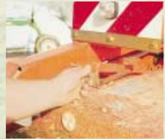
Zum Transport lässt sich das Mäherwerk mit zwei Bügel (o.) links und rechts an der Schwinge zusätzlich fixieren. Zum Abhängen des Frontmähers kann man außerdem den Bock (l.) feststellen.
