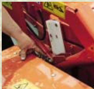
Die Gleitschienen an beiden Parallelogrammen sorgen für eine verschleißfreie Führung beim Pendeln in kuperem Gelände.
