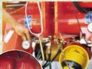
Das GMD 902 ist mit Lift-Control ausgestattet. Mit Hilfe der zwei Druckspeicher lässt sich der ideale Auflagedruck des Mähbalkens vom Traktorsitz aus einfach einstellen.
