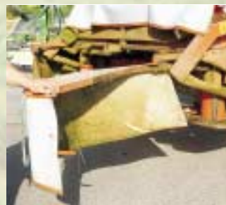
Die seitlichen Schutztücherhaltungen müssen zum Straßentransport nach vorne unter die Frontabdeckung geklappt werden.
