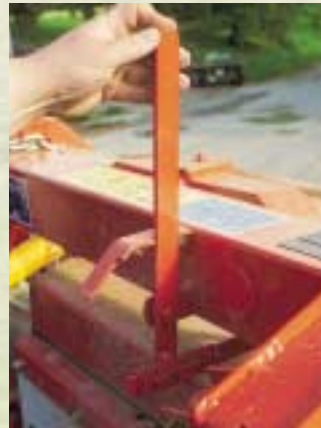
Zum Transport lässt sich das Mäherwerk mit zwei Bügel (o.) links und rechts an der Schwinge zusätzlich fixieren. Zum Abhängen des Frontmähers kann man außerdem den Bock (l.) feststellen.
