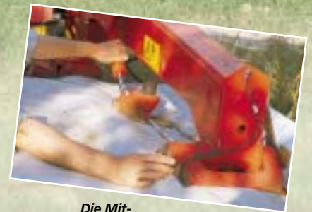
Die Mittenaufhängung ist Garant für eine optimale Seitenpendelung des Mähbalkens. Zum Transport in Längsstellung wird der Balken mit dem kleinen Zylinder fixiert.
