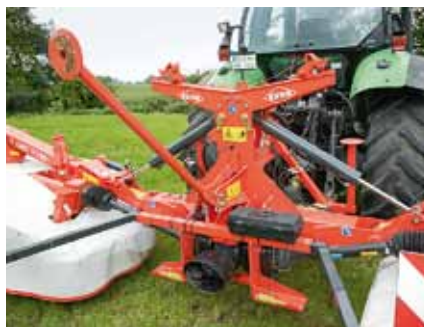
Die Zylinder haben zwei Kammern, eine zum Ausheben am Vorgewende und eine zum Klappen. Verbesserungswürdig sind die Abstellstützen, man kann sich den Kopf stoßen. Vorbildlich ist der Werkzeugkasten.
