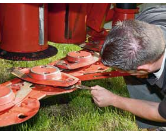
Dank Schnellwechsler geht der Klingenwechsel sowohl vorn als auch hinten (hier vorn) zügig vonstatten. Auffallend ist die verstränkte Klingensform.
