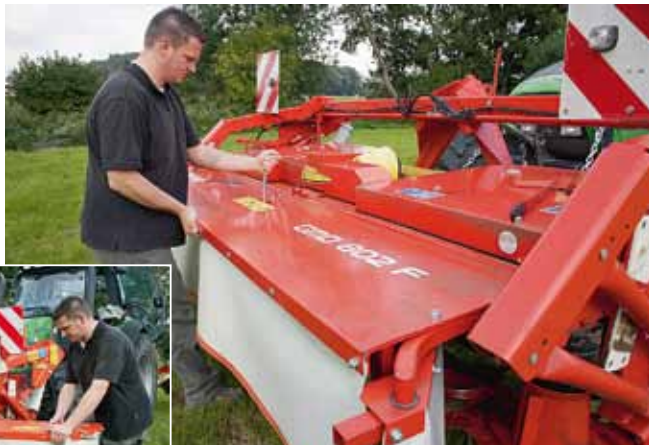
Zur Umstellung von Straße auf Einsatz müssen die Fronthaube mit Werkzeug hochgeklappt und die Seitenteile ausgeklappt und mit dem Gummiseil arretiert werden.
