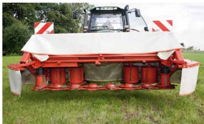
8 Mäh-scheiben und 4 angetriebene Schwad-trommeln arbeiten am Front-mähwerk. Ein „Schnellausbausystem“ der inneren Trommeln wäre toll, so ist einige Schraubarbeit notwendig, um bei entsprechender Schlepperspur breit abzulegen.
