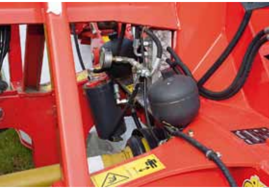
Mit den beiden Druckspeichern, dem Ausgleichsbehälter und dem Absperrhahn lässt sich der Auflagedruck der heckseitigen Mähbalken für beide Seiten einstellen. Das Manometer ist vom Schlepper kaum zu sehen.
