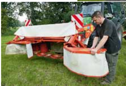
Zur Umstellung von Straße auf Einsatz müssen die Fronthaube mit Werkzeug hochgeklappt und die Seitenteile ausgeklappt und mit dem Gummiseil arretiert werden.
