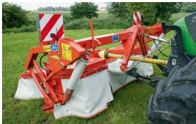
Das GMD 802F hat einen nach vorn offenen Rahmen aus Quadrat-rohren. Die Führung des Mähwerks erfolgt über je zwei Lenker an den Seiten, die Entlastung übernehmen zwei einstellbare Spiralfedern. Optional wird ein Koppeldreieck für den Anbau geliefert.
