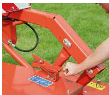
Die Transportverriegelung greift bei der Straßenfahrt über den Zapfen oben am Rahmen. Der schwenkbare Anschlag an der Kolbenstange verhindert ein zu weites Absinken beim Abstellen.
