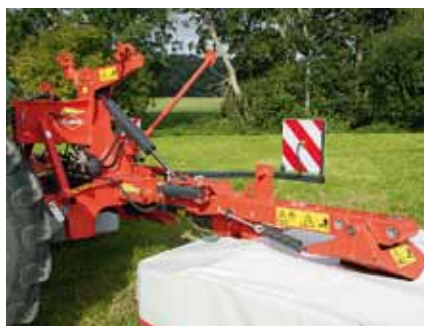
Die Tragarme haben drei Bohrungen zur Arbeitsbreitenverstellung. Der kleine Zylinder gehört zur Anfahrtsicherung.
