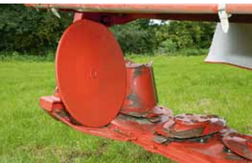
Die hinteren Mäheinheiten haben den „Optidisc“-Mähbalken von Kuhn. Die äußeren Scheiben sind mit einer Förderereinheit ausgestattet, die passiv angetriebene Schwadscheibe ist höhenverstellbar.
