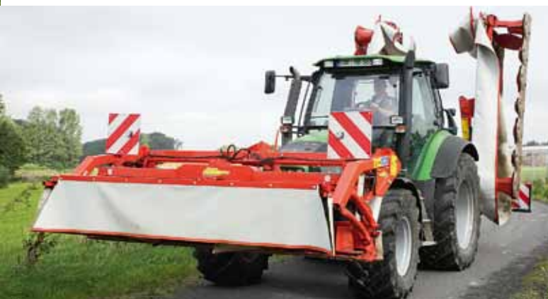
Zur Straßenfahrt müssen die Seitenhauben von Front- und Heckmäherwerken eingeklappt werden. Die Transporthöhe liegt unter 4 m. Die Gewichtsverteilung ist gut, nur die Sicht nach vorn ist durch den Tragrahmen eingeschränkt.
