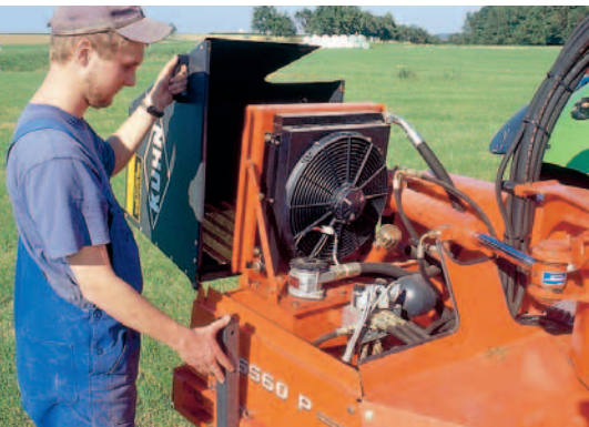
Ein Ventilator mit E-Motor hält den 70 l-Ölhaushalt auch im Dauerbetrieb thermisch stabil. Ein Stundenzähler ist Serie.
