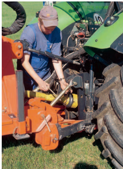
Die Universal-Anbaukonsole (1533 €) verhindert Spiel. An- und Abbau des Mähers dauern dadurch aber 30 Minuten.
