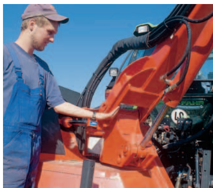
Solide: In den Drehlagern sitzen schmier- und wechselbare Kammerbuchsen. Die Anlenkpunkte sind extra verstärkt.
