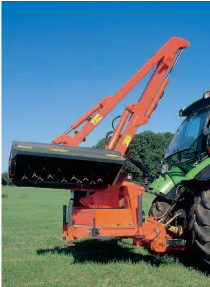
Zum Transport schwenkt man den Mähkopf nach hinten. Eine Transportkonsole zum Abstützen haben wir vermisst.
