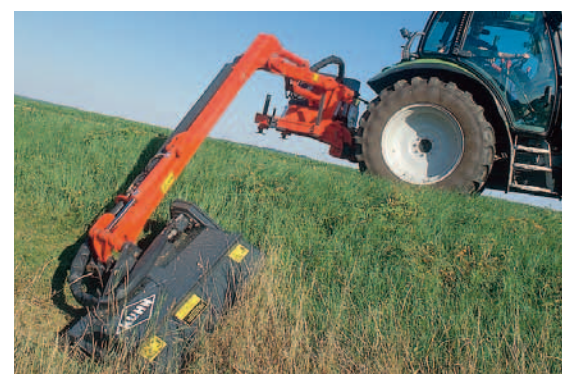
5,5 m-Reichweite ist für flexibles Arbeiten Untergrenze. Gut: Eckt man an, weicht der Arm nach hinten und oben aus.
