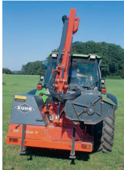
Um den 5560 P mit 1445 kg zu hantieren, sind 100 PS und 5 t Eigengewicht Untergrenze. Eingeklappt ist er 3,8 m hoch.
