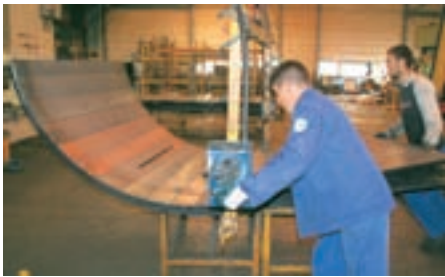
Die Kuhn-Konstrukteure sind fest davon überzeugt, dass das Abkanten in einzelne Segmente des Behälters entscheidende Vorteile beim Mischen bringt. Der Zeit- und damit die Kraftstoffersparnis seien erheblich.
