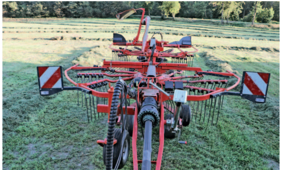
Mit einem Kreiseldurchmesser von 2,90 m ist die Maschine auch ohne Abnehmen der Zinkenarme sicher auf der Straße unterwegs.
