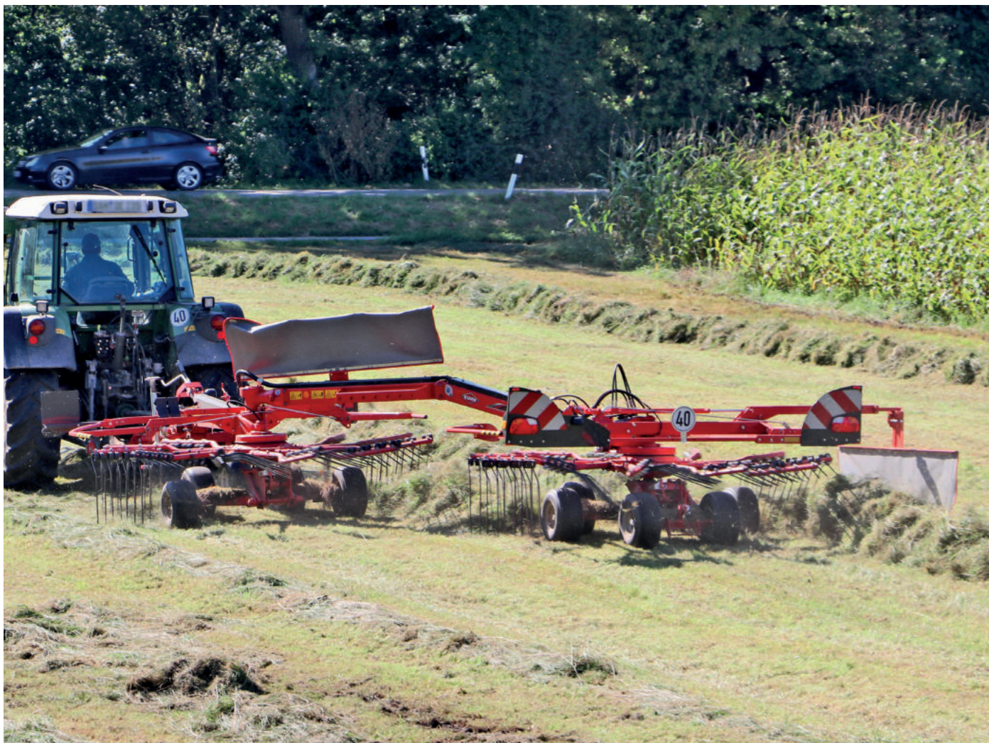
Der GA 6632+ ist ein Zweikreiselschwader mit Seitenablage und 6,45 m Arbeitsbreite.
