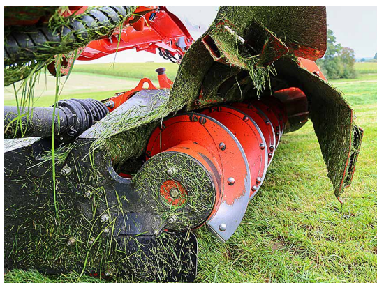
Die Schnecken führen das Futter zur Mitte und legen es in das Schwad.
