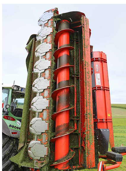
Acht Mähscheiben schneiden das Futter. Das Mähwerk klappt kompakt zusammen.
