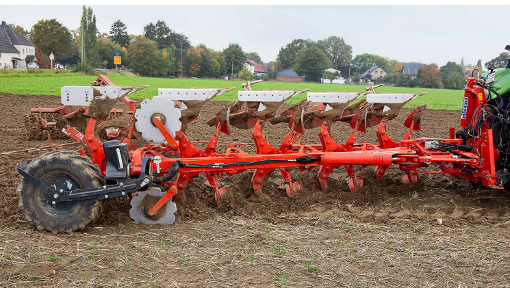
Das massive Rad dient als Transport-, aber auch als Tiefenführungsrad beim Pflügen.
