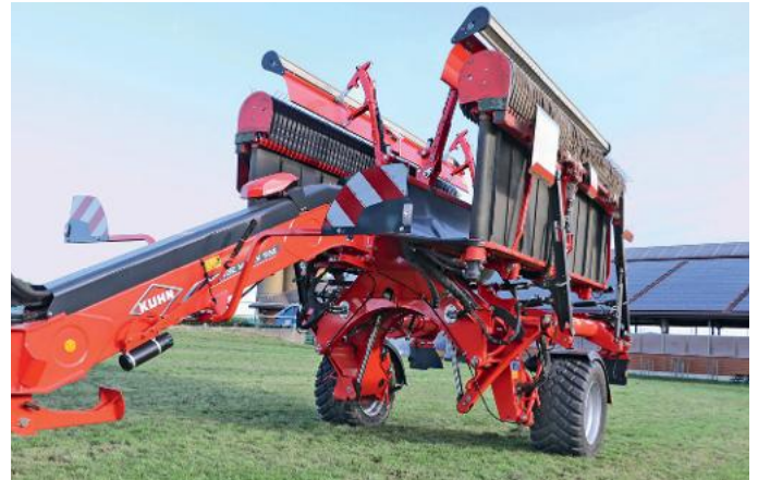
In Transportstellung sieht man schön, dass die Pick-up über große Gleitkufen in der Tiefe geführt wird.
