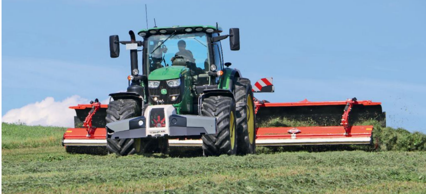
Der Bandschwader Merge Maxx von Kuhn recht maximal 9,50 m Gras zu einem Schwad zusammen. Er kann rechts, links oder in der Mitte ablegen.
