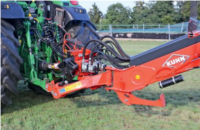
Angehängt wird der Bandschwader in den Unterlenkern. Die Ölversorgung erfolgt über die LoadSensing Hydraulik und die vier Zapfwellenpumpen.
