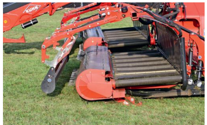
Der Aufbau ist vergleichsweise simpel. Die Pick-up fördert das Futter auf das Band. Eine Rolle und der Deflektor sorgen möglichst wenig Verluste.
