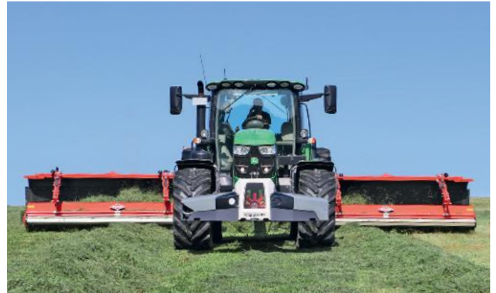
Auseinandergeschoben kann in der Mitte ein Schwad bis 2,20 m Breite abgelegt werden. Schmalere Schwade gehen zu lasten der Arbeitsbreite.
