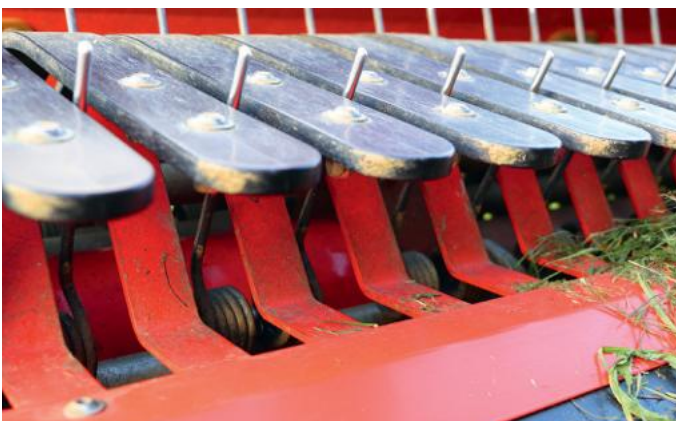
Die Pick-up-Zinken lassen sich jetzt leichter wechseln als beim Vorgänger. Das Futter gleitet über den Kunststoffrechen auf das Förderband.
