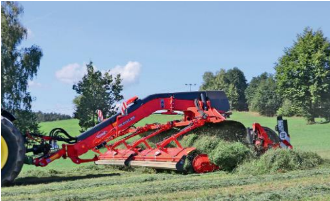
Sind die Seitenteile zusammengeschoben, wird das Futter von einem Band auf das nächste übergeben und seitlich links oder rechts abgelegt.
