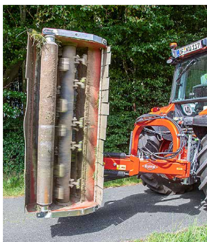
Jeweils fünf Hammerschlegel sind in vier Reihen auf dem Rotor montiert. Sie drehen mit 2325 U/min bei 540 Zapfwellentouren.
