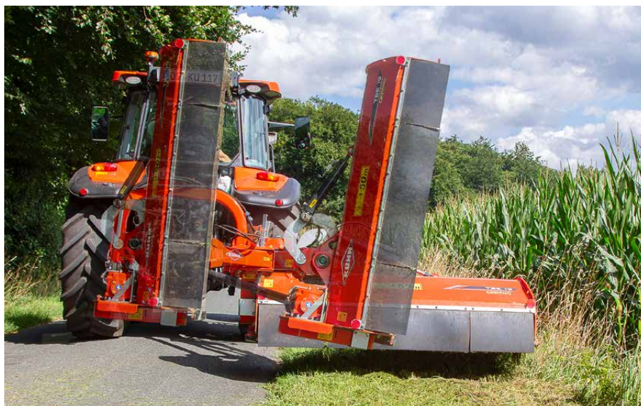
Der seitliche Ausschub beträgt bis zu 1,59 m! Das ist viel und macht den Einsatz des Werkzeugs sehr flexibel. Fotomontage: Esser
