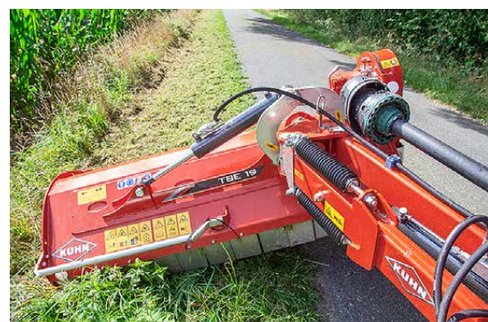
Zwei Spiralfedern spannen den Ausleger vor. Bei Überlast schwenkt der Mulcher nach hinten aus.
