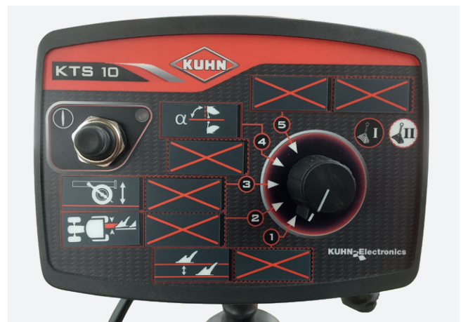
Bild 3: Vorwahl der Hydraulikfunktion an der Bedieneinheit KTS 10
