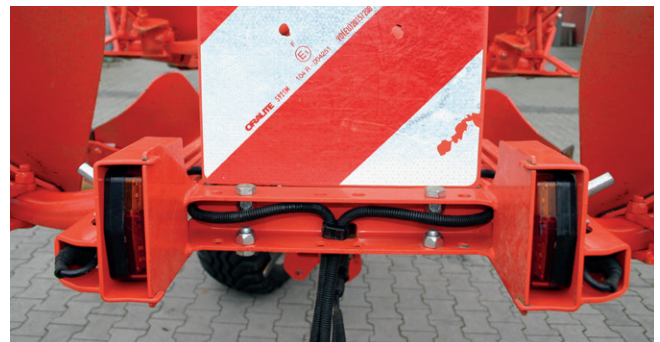
Bild 7: Beleuchtung eingeklappt für Feldarbeit
