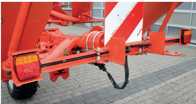
Bild 6: Beleuchtung ausgeklappt für Straßenfahrten
