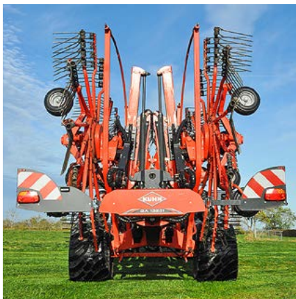
Ohne Arme abzunehmen, bleibt der Kuhn-Schwader unter 4 m Transporthöhe.
