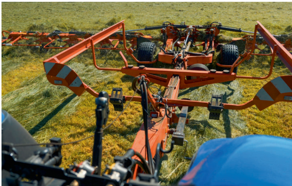
Der steile Wurfwinkel des Giroheuers soll eine Schwadbildung verhindern.
