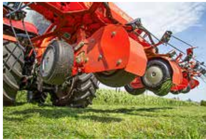
Die mittleren Kreisel werden von einer Tandemachse gestützt.
