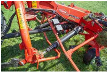
Zwei Stoßdämpfer stabilisieren und zentrieren die Maschine bei der Arbeit.
