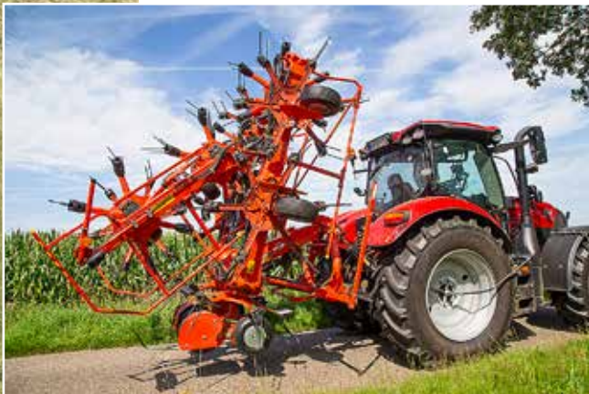
Breit im Feld, kompakt auf der Straße. Zwölf Kreisel als Anbauwender hat es bisher nicht gegeben. Fotos: Bensing, Huelsmann
