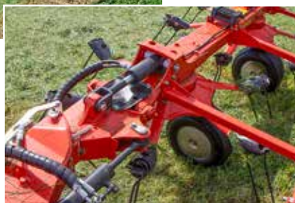
Am Vorgewende können die Kreisel mit einem ew-Steuergerät ausgehoben werden.
