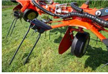
Die Zinkenarme sind in den geprägten Teller eingelassen. Das wirkt sehr stabil.
