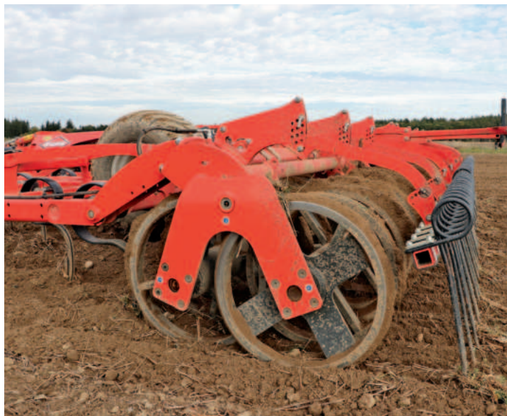
Die Doppelwalze mit U-Profil sorgt für eine gute Rückverfestigung und hinterlässt eine gut strukturierte Bodenoberfläche.
