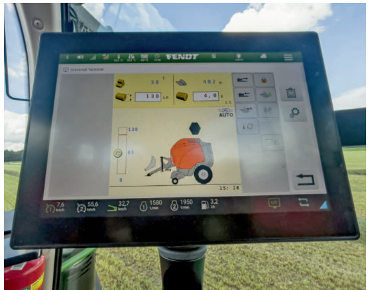
Als ISOBUS- Presse läuft die Bedienung auch ohne zusätzliches Display über das Traktorterminal – für das Pressen aus unserer Sicht völlig ausreichend.
