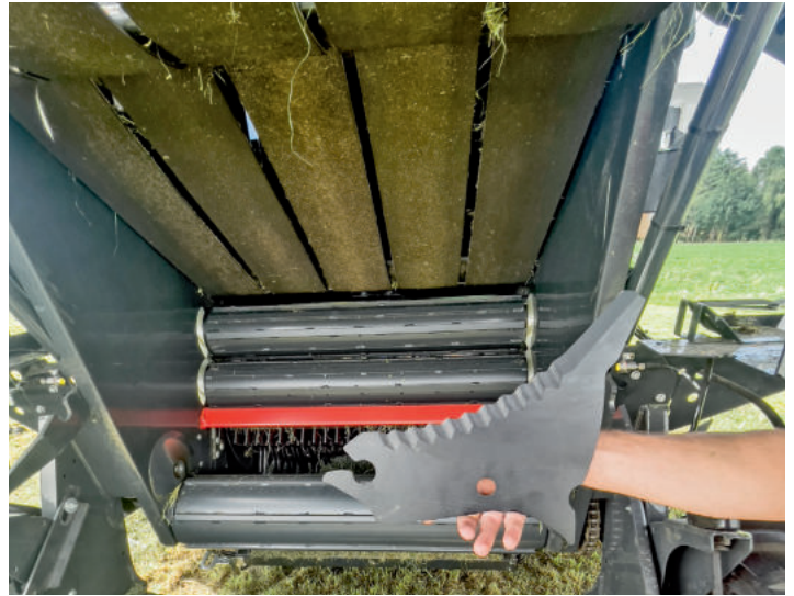
Das Schneidwerk bietet maximal 23 Messer. Sie werden von hinten eingelegt und zentral verriegelt. Im Hintergrund die drei Presswalzen.
