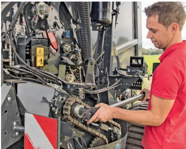
Rotor und Pick-up lassen sich vom Riemenantrieb entkoppeln. Wenn alles nicht mehr hilft, dreht der Fahrer den Rotor mit einem Hebel zurück.
