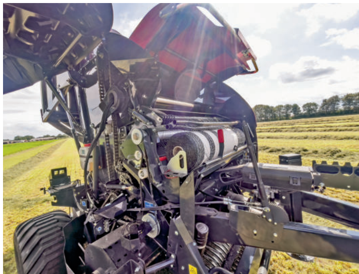
Das Netz einlegen und -fädeln geht einfach vom Boden aus. Die über 40 kg schwere Rollen müssen aber ohne Hilfsmittel auf Brusthöhe gehievt werden.
