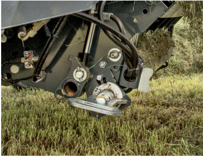
Händisch drehen, um die Messergruppen zu schalten – an einer ISOBUS- Presse sollte das hydraulisch funktionieren.
