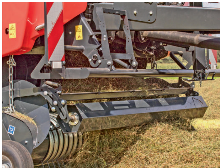
Kuhn setzt auf eine gesteuerte Pick-up mit fünf Zinkenreihen. Wichtig in Sachen Leistung: der neue Rollenniederhalter mit gefederter Zinkenrechen.
