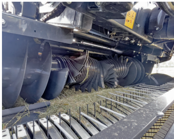
Förderschnecken und Rotor liegen auf einer, statt auf getrennten Wellen. Das ist der Integralrotor, wie er 1996 in Geldrop erfunden wurde.
