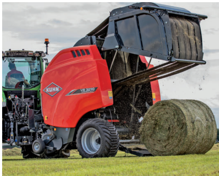
Die Heckklappe ist sehr flink und schließt sekundenschnell. So kann man schnell weiterpressen. 22,5er-Reifen sind aus unserer Sicht ein Muss.
