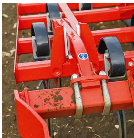
Die Walzenanlenkung ist in Taschen geführt – das sorgt für Stabilität auch beim Transport.
