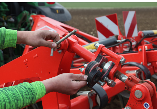
Zur Einstellung der Arbeitstiefe werden Clips eingeschwenkt und per Bolzen arretiert.
