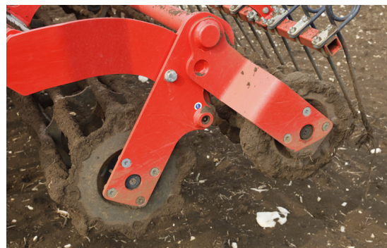
Da die Doppelwalze pendelnd angelenkt ist, sind immer beide Walzen gleich belastet.
