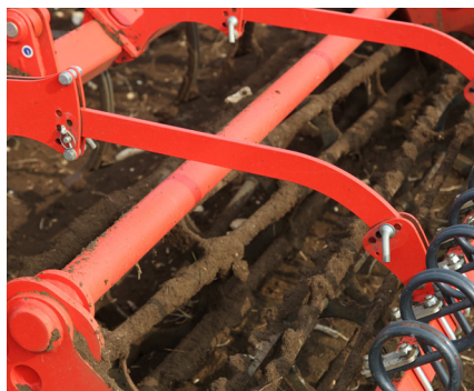
Der optionale Striegel kann getrennt in seiner Arbeitstiefe und Neigung angepasst werden.
