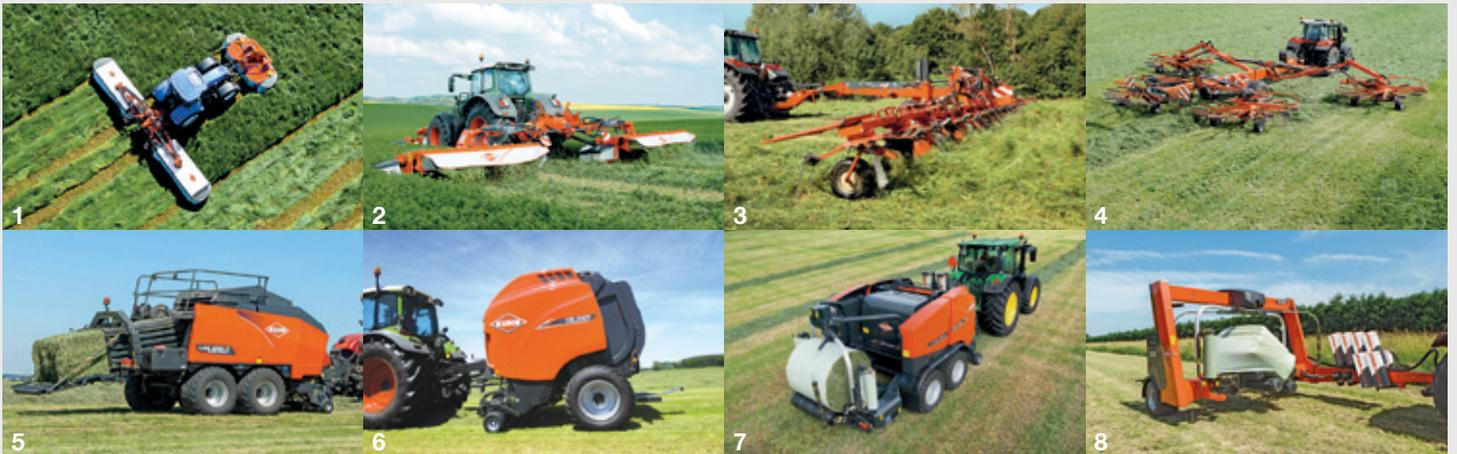
1. Dreifach-Scheibenmäher-Kombination - 2. Dreifach-Scheiben-Mähknickzetter-Kombination - 3. Großflächenheuer - 4. Giroschwader mit vier Kreiseln - 5. Großpackenpresse - 6. Rundballenpresse - 7. Press-Wickelkombination - 8. Wickelgerät.
