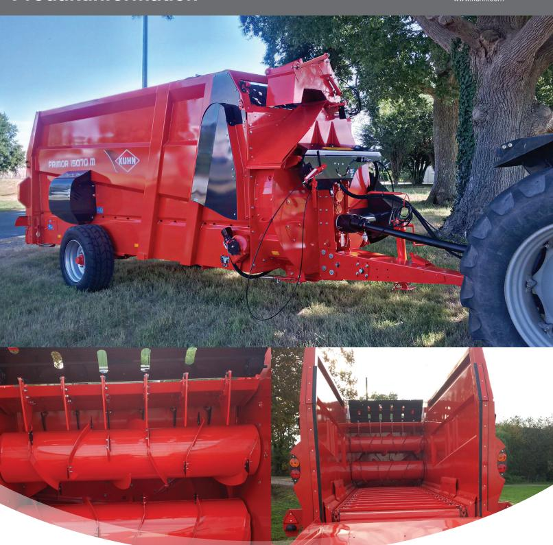
Der PRIMOR 15070 M ergänzt die Baureihe der Universalwagen mit großem Fassungsvermögen zum Einstreuen und zum Verteilen aller Futterarten. **Er kann bis zu vier Quaderballen 1,30 m x 1,20 m x 2,70 m bzw. drei Rundballen mit bis zu 2 m Durchmesser aufnehmen**.
