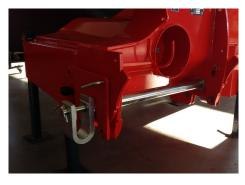
Für einen leichteren Anbau ist eine halbautomatische Kuppelstange vorhanden.
