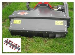
• Der Mähkopf hat einen Riemenantrieb sowie einen beidseitig verwendbaren Rotor (zur Verschleißoptimierung der Rotorlaschen). «breite» Rotor Am 60 14 mm Y-Universalschlägel an Schäkeln montiert. Der gesamte Mähkopf wird von einer Stützwalze mit 140 mm Durchmesser und abnehmbaren Lagerungen geführt.
