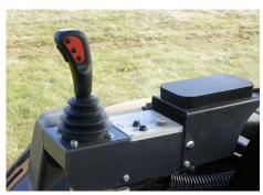
Die Einhebelbedienung vom Typ HE (hydraulisch/elektrisch) verfügt über Proportionalfunktionen. Dies macht es möglich, die Bewegung von Drehgelenk, Hauptarm, Außenarm und Mähkopf zu kombinieren.
