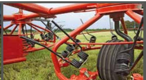
Pannensichere Reifen mit Rillenprofil
