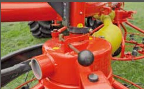
Hebel zum Ändern der Drehrichtung und Aufkleber mit Umrüstungsanleitung (Haybob 360)
