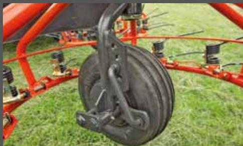
Höhenverstellbare, pannensichere Reifen mit Rillenprofil (Haybob 360)
