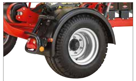
Große Schutzbleche, damit die Folie beim Transport nicht beschädigt wird
