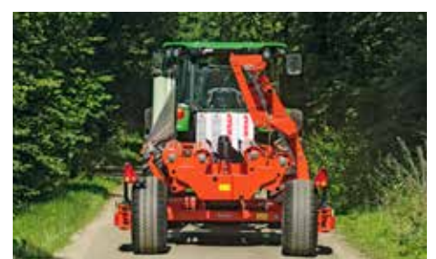
Beim Straßentransport können die Räder nach innen geklappt werden, um die Transportbreite zu verringern. Die hydraulische Klappsteuerung ist optional
