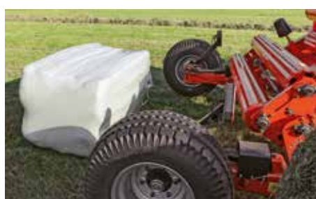
Durch das tief liegende Fahrgestell lässt sich der Ballen sanft ablegen und ist vor Folienschäden geschützt
