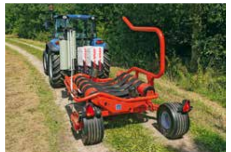
Geringere Transportbreite durch Einklappung eines Rades
